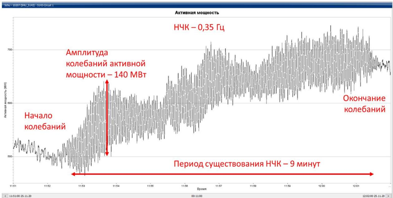
Рисунок 2.3 – График изменения активной мощности по ВЛ-500кВ «Шу-Фрунзе», МВт
