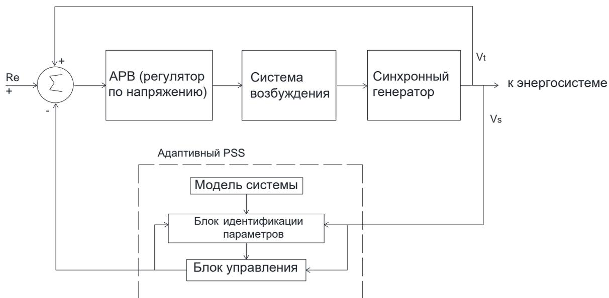
Рисунок 3.2 – Схема регулирования с адаптивным PSS.
