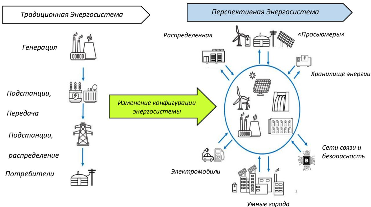
Рисунок 4.1 – Изменение конфигурации энергосистемы при реализации концепции Smart Grid
