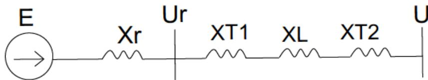
Рисунок 1.3 – Схема замещения сети
