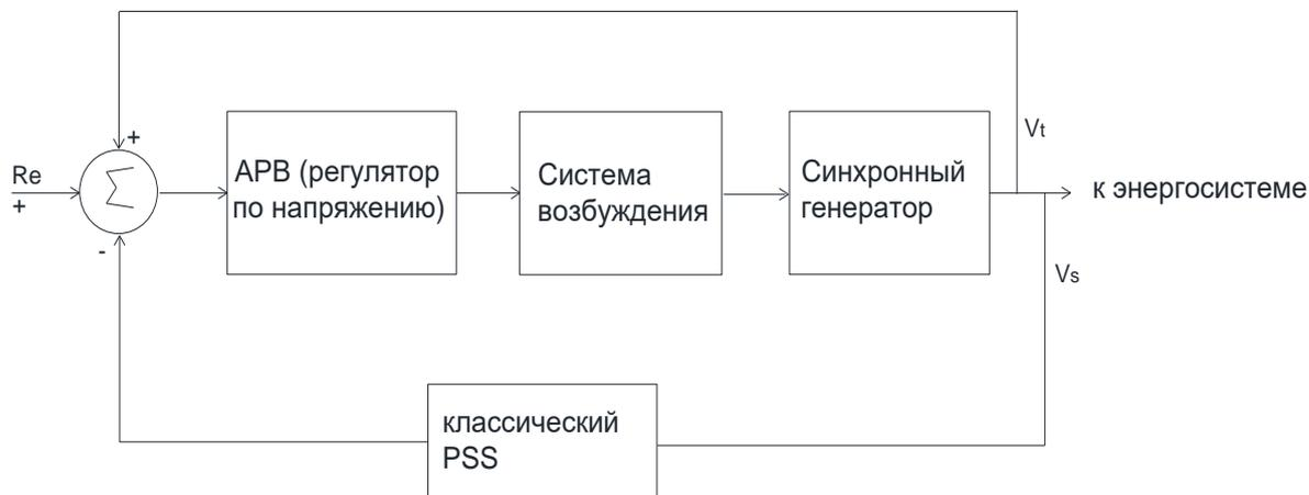
Рисунок 3.1 – Схема регулирования при классическом PSS.
